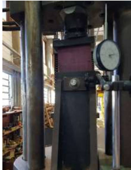
Figura 1: Ensaio de embutimento na direção paralela às fibras
