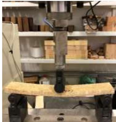
*Figura 3: Realización del ensayo MOE y MOR*
