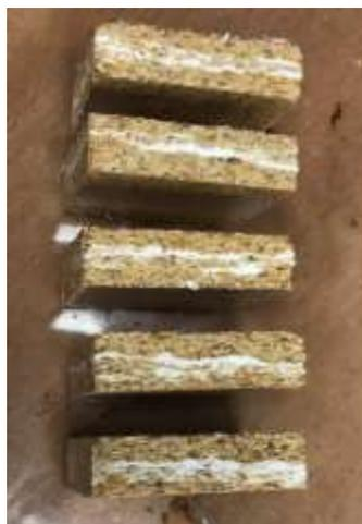
*Figura 2: Muestras para ensayo de adhesión interna*
