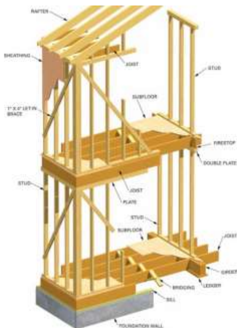
Figura 1. Sistema constructivo Platform-frame
