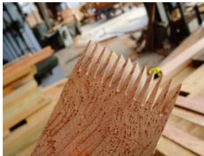
*Figura 2: Perfil dentado longitudinal*
