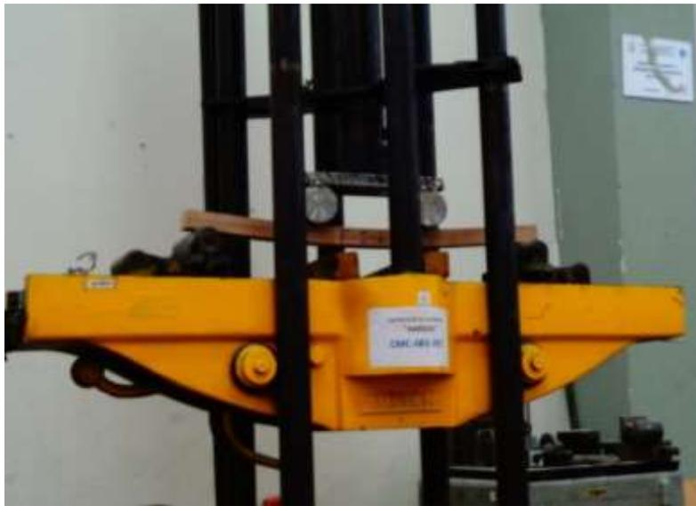
Figura 5: Ensayo de flexión a 4 puntos
