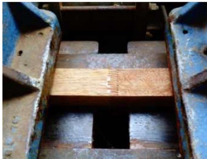
*Figura 4: Unión de piezas dentadas*
