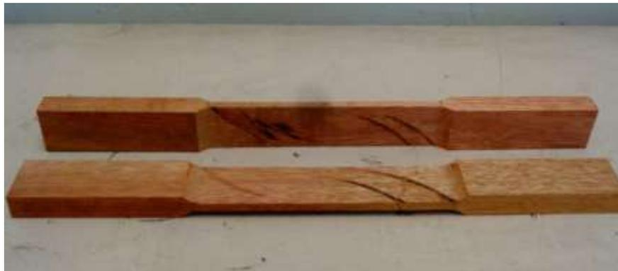
*Figura 6: Probeta moldeada para ensayo a tracción*
