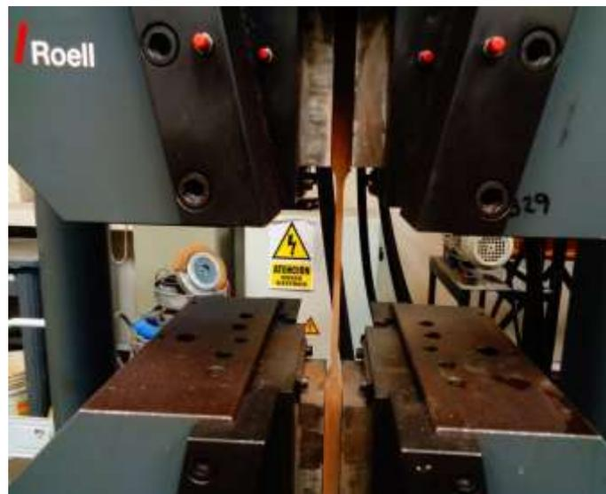
*Figura 7: Ensayo de tracción paralela a la fibra*
