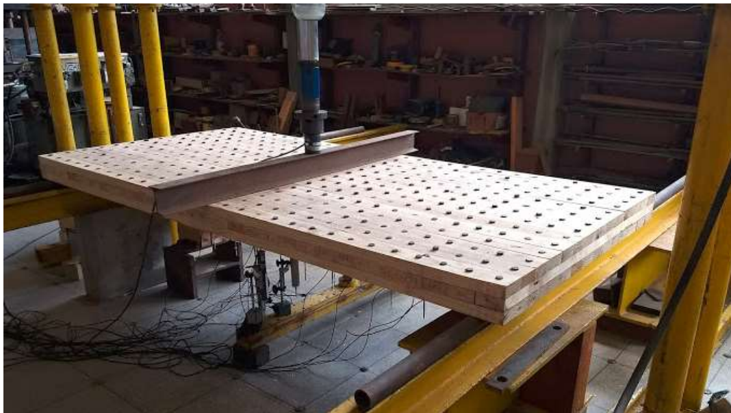
Figura 4: Painel DCLT durante ensaio
