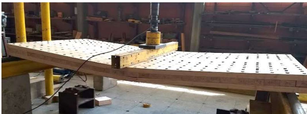
Figura 5: Painel DCLT após ruptura por tração
