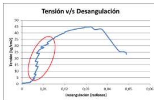
Figura 3: Curva tipo de tensión de corte – deformación angular de probetas. (Romero y Rossi 2016)
