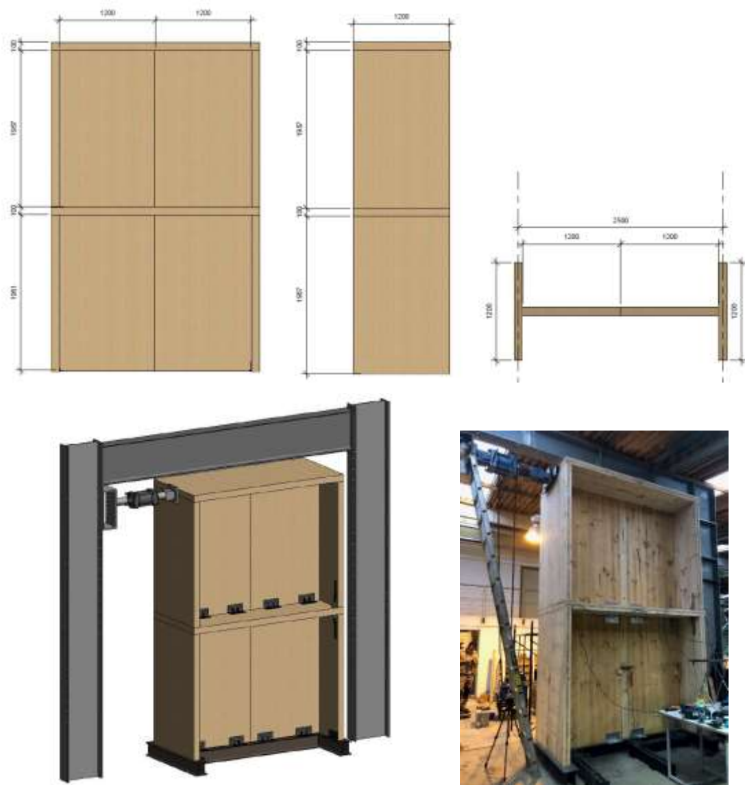
Figura 1: Dimensiones, vistas de los muros e implementación en laboratorio
