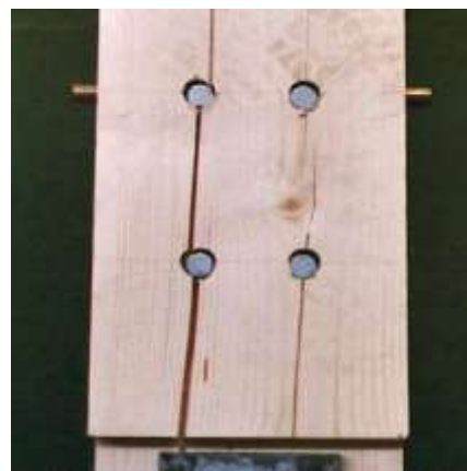
Figura 1. Uniones tipo clavija: falla dúctil con clavos (Viaje de Estudios MCM_UBB, septiembre 2009, Universidad de Biberach, Alemania) y falla frágil con pasadores (Blass & Schadle, 2011)
