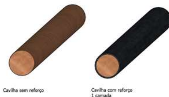
Figura 3 - Perspectiva do corpos-de-prova do ensaio de flexão nas cavilhas.
