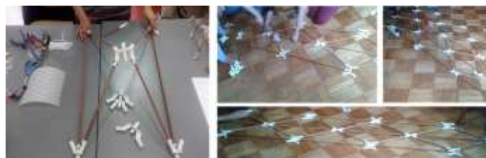
Figura 7: Prototipo de módulo ensamblado (izq.) y Montaje 1 prototipo escala 1:3. (Der.)
