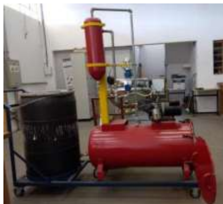
Figura 1: Autoclave para ensayo de delaminación de línea de cola
