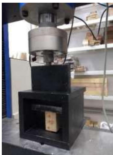
Figura 2: Dispositivo de ensayo de cizallamiento en la línea de cola
