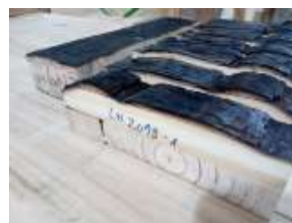
Figura N° 9: Medición de la capa carbonizada y resistente para LN2018
