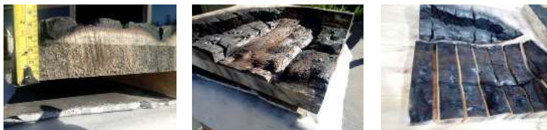
Figura N° 8: Medición de la capa carbonizada y resistente para MN2018.
