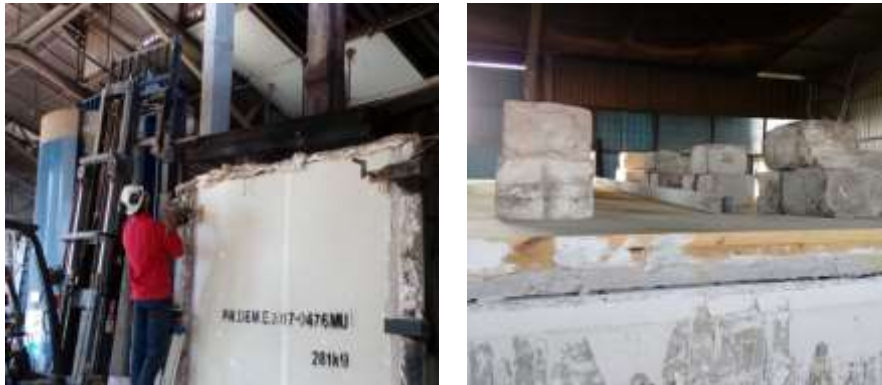
Figura N° 1: Sistema de aplicación de carga para muros y losas.
