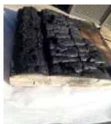
Figura N° 9: Medición de la capa carbonizada y resistente para LN2018
