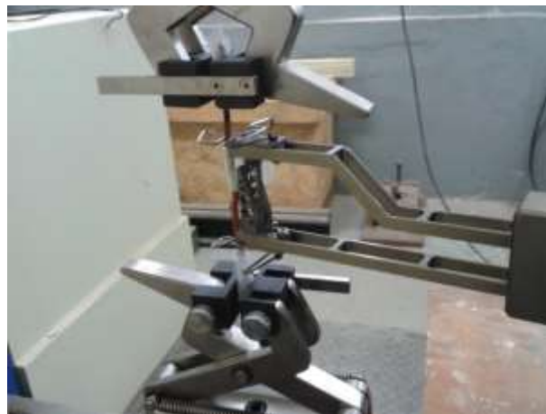
Figura 1. Ensaio de tração em caule de muda de eucalipto.
